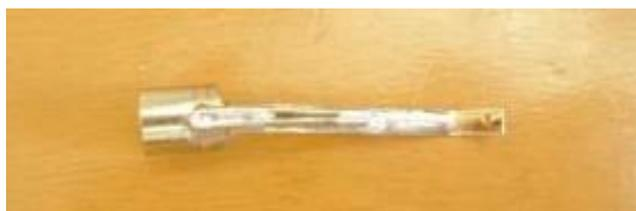
電極を真ん中ギアの角孔とプロペラ側の角孔の位置を合わせ、その角孔に先端の回転電極を挿入し、ギアの中心部に嵌め込みます。
